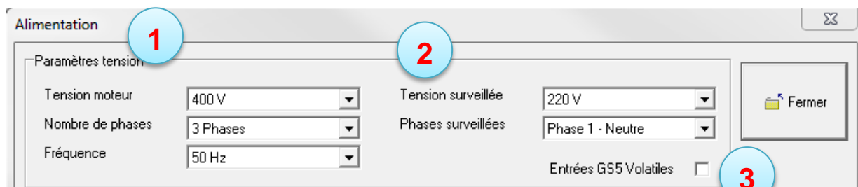
Ecran GemPro 8 : Paramétrage alimentation moteur et entrée de mesure tension GemStart5
